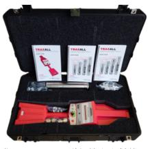
送信機と受信機で構成されていて、送信機を発射前のピグに挿入することで、 ピグの現在地を確認することが出来ます。
